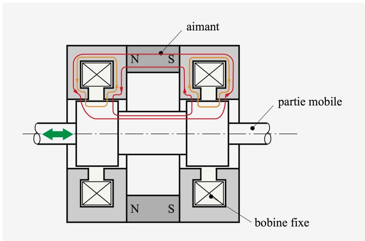
$$F = \frac{1}{2} \frac{dM_b}{dx} \Phi_b^2 + \frac{1}{2} \frac{dM_a}{dx} \Phi_a^2 + \frac{dM_b}{dx} \Phi_c \Phi_b$$
